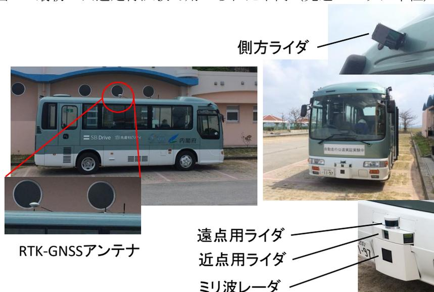
2回目の実証実験は2017年6月25日から7月8日の期間に、新石垣空港から石垣市離島ターミナル間往復32kmの公道で行われた。1日当たり1万台程度の交通量がある実際のバスの運行路線において、定時運行による試験走行が行われた。走行経路中に信号交差点が複数箇所存在したが、その中の4か所で信号協調の試験が行われた。信号サイクルを受信し、交差点到達時の信号灯色を予測することにより、信号が赤になる場合は、あらかじめ減速を行う。地上信号機から車両へ送信する手法が未整備であったことから、信号サイクルはあらかじめ車載コンピュータに保存して走行したが、実現可能性を示すデモンストレーションを行うことはできた。
